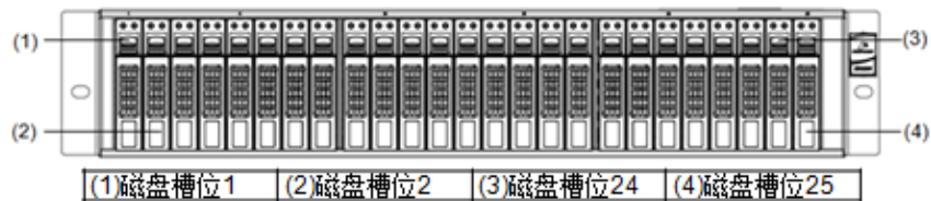
图6-20 DSU2625 磁盘槽位编号示意图
